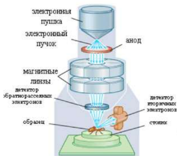
Рис. 112. Принципиальная схема сканирующего электронного микроскопа
